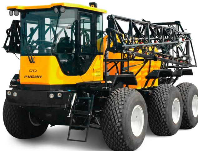
**Производительность до 700 га/сутки    Ширина захвата - 24-28 м    Расход - 5-300 л/га    Давление на почву - около 13 кПа**
