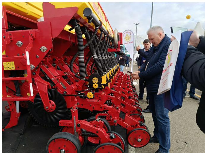
Что особенно отметили фермеры, это устройства для скоростного точного высева семян и удобрений, установленные на сеялке Panther SM от бразильского завода Toplanting. Данные устройства обеспечивают равномерное внесение даже при скорости посева 15 км/ч. В этом убедились благодаря демонстрационному стенду, на котором было видно расположение семян при разной скорости. Многие участники изъявили желание модернизировать свои сеялки такими устройствами, и мы готовы в этом помочь.
