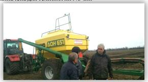
ДОН 651 - это совместная разработка Наир с аргентинским производителем Gherardi, посевной комплекс имеет ширину захвата 10,7 метра, турбоножи (колтеры), у которых разнесены посевные корпуса, что дает возможность сеять по любому фону и количеству пожнивных остатков, в том числе кукурузы и подсолнечника.
