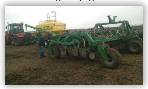
Бункер объемом 10 000 литров поделен на 2 части: 40% на 60%. Турбина (CRARY, США) с приводом от гидромотора (Parker, США) создает поток воздуха для транспортировки семян и удобрений к сошнику. Под бункером расположены 2 дозатора с катушками (с мелкими ячейками, средними или крупными). Норма внесения семян и удобрений регулируется дозаторами последнего поколения с бесступенчатой шкалой. Все семяпроводы одинаковой длины, что обеспечивает равномерность подачи семян.
